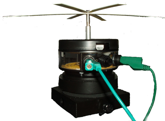
Obrázek 5: Třepadlo Pasco s rezonančními proužky
