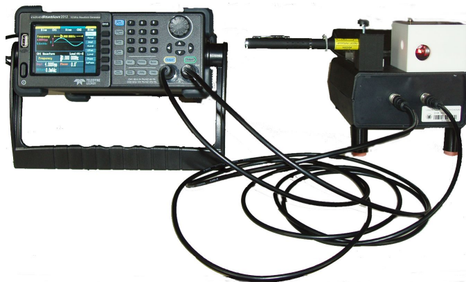
Obrázek 2: Generátor Le Croy (vlevo), laserové ukazovátka a galvozrcadla
