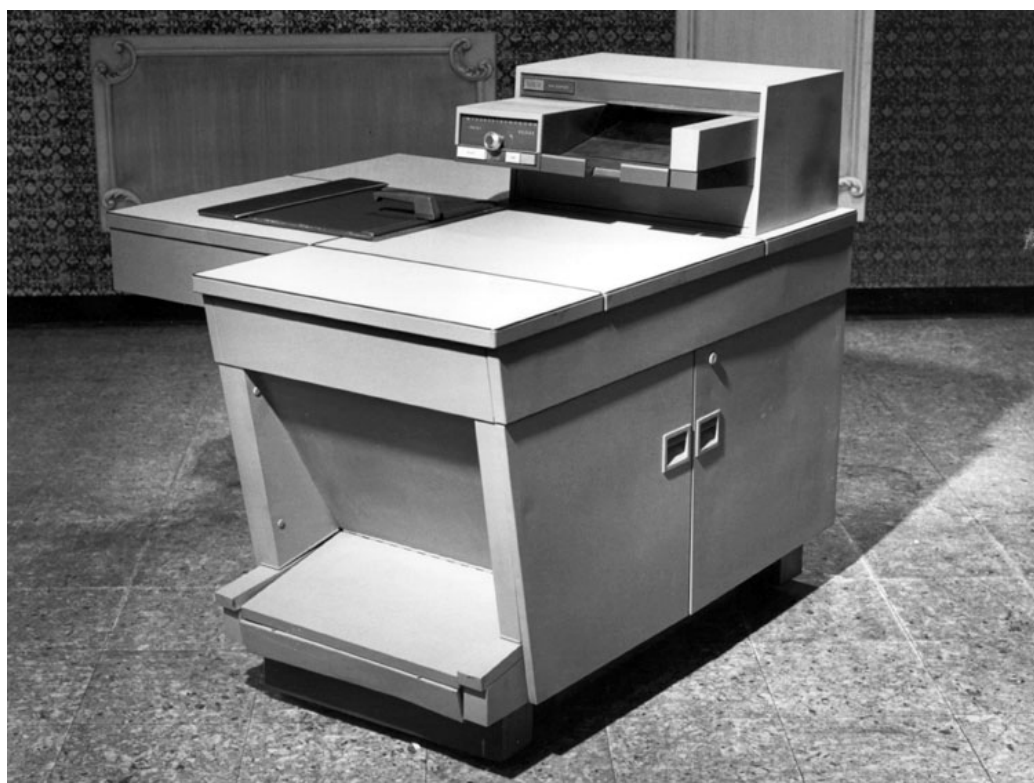
Obrázek 21: Xerox 914 - První komerčně úspěšný xerox
