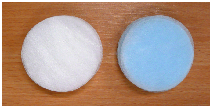
Obrázek 5.1: Chitosanové filtry. Vlevo jsou čisté kupony, vpravo kupony s adsorbovanou mědí (po vysušení).
