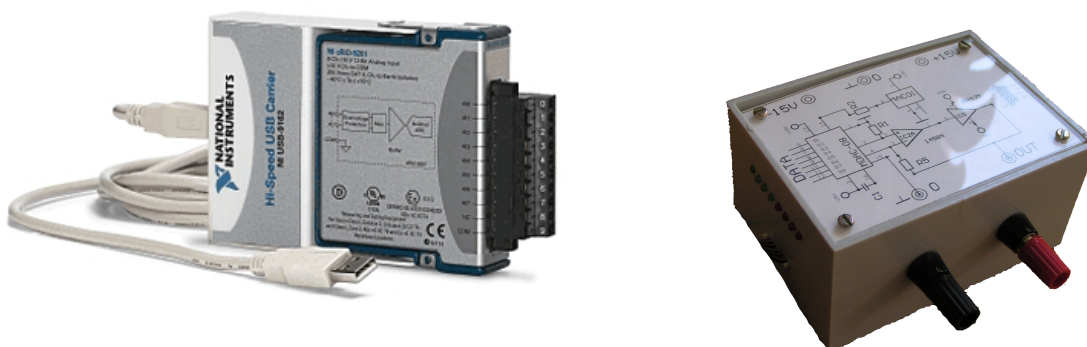
Obrázek 9.13: Dva D/A převodníky: vlevo profesionální 4-kanálový 16-bitový převodník USB-9263 firmy National Instruments, vpravo jednoduchý osmibitový D/A převodník MDAC-08
