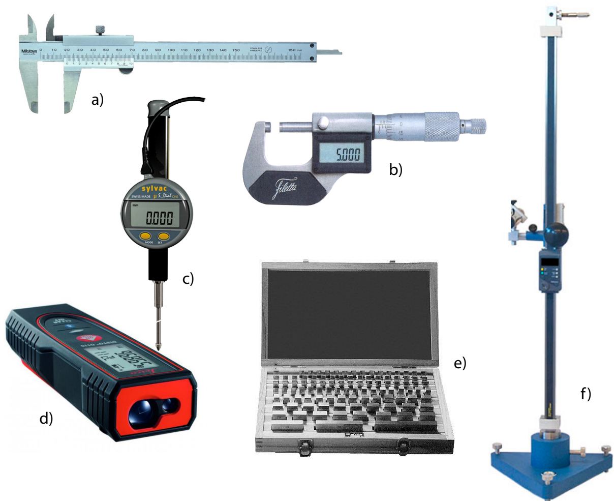
Obrázek 1.1: Měřidla délky: a) posuvné měřítko, b) mikrometr, c) úchylkoměr, d) laserový dálkoměr, e) koncové měřky, f) katetometr.
