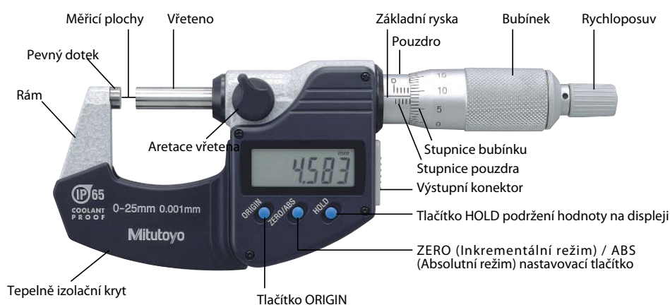
Obrázek 1.5: Mikrometr s analogovými stupnicemi a digitálním displejem. V elektronické verzi si lze obrázek prohlédnout při větším zvětšení.
