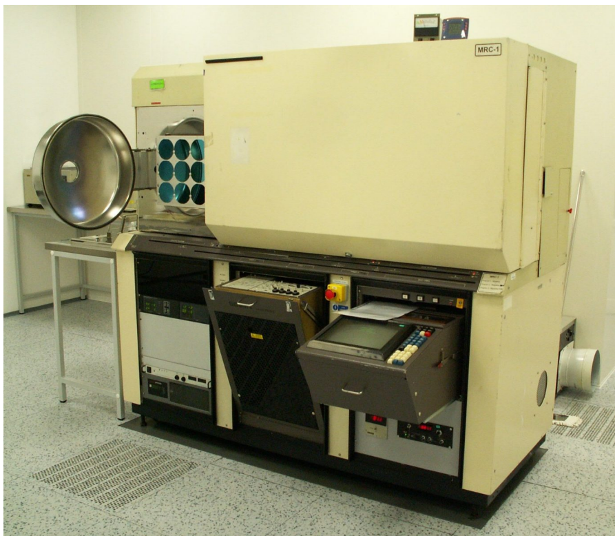
Obrázek 7.8. Naprašovačka MRC 603 s otevřenou předávací komorou, ve které je paleta s devíti naoxidovanými deskami.
