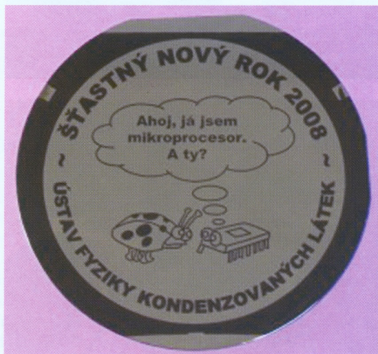
Obr. 5 Křemíková deska se součástkami („čipy“) vyrobenými v praktiku a uchycená ve vakuové pinzetě (nahore). Výsledek leptání naprašované hliníkové vrstvy na křemíku (dole).
