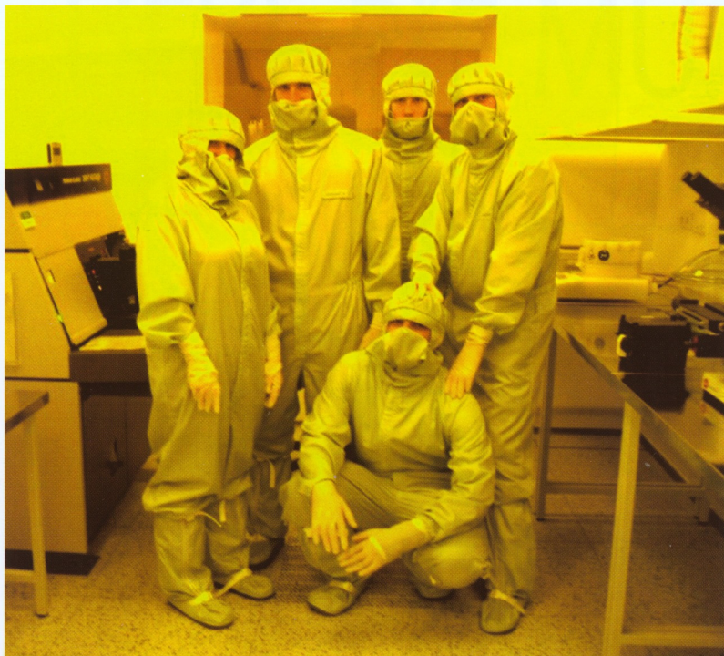
Obr. 4 Studenti fyziky z PŘF MU v čistých prostorách na prvním praktiku z fotolitografie. Speciální bezprašné kombinézy jsou nezbytné pro zabránění kontaminace křemíkových desek lidmi. Místnost fotolitografie je nejvíce citlivá na bezprašnost, žluté osvětlení je nutné kvůli práci s fotocitlivým lakem.
