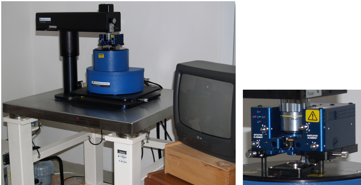
Obrázek 4.5. Skenovací mikroskop atomových sil na antivibračním stole (vlevo) a detail snímací hlavy (vpravo).
