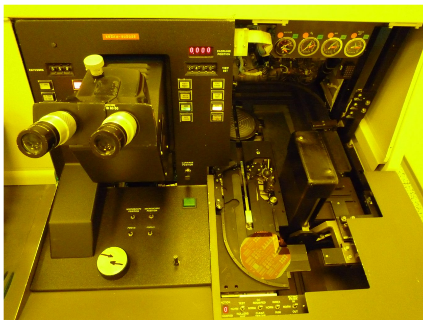
Obrázek 3.4. Ovládací a základní část optického litografu Perkin-Elmer 340HT.
