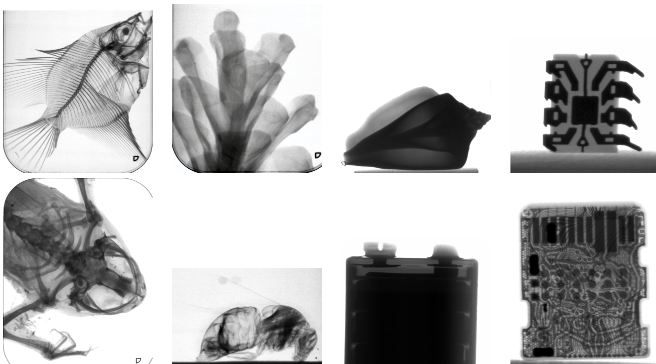
Obrázek 5.3. Příklady radiogramů pořízených na paměťové fólie VistaScan v pořadí: akvarijní ryba, šiška borovice, mořská škeble, integrovaný obvod, žába, čmelák, 9V baterie, micro M2 paměťová karta.
