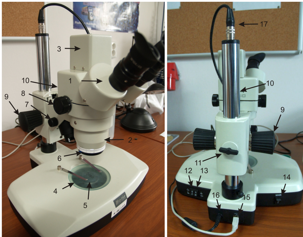
Obrázek 2.12. Přehled ovládacích prvků mikroskopu: 1. stereo-okulár, 2. stereo-objektiv, 3. digitální kamera, 4. matné podložní sklo s možností manuální rotace, 5. lineární polarizační folie pod matným sklem, 6. polarizační filtr, 7. regulace směru horního osvětlení, 8. regulace zvětšení, 9. zaostřování, 10. táhlo pro převedení obrazu z pravého okuláru do digitální kamery, 11. aretační šroub výšky mikroskopu, 12. spínač horního osvětlení, 13. spínač dolního osvětlení, 14. hlavní síťový spínač, 15. výstup usb kamery, 16. napájecí kabel, 17. kabel kamery. Na pravé straně základny mikroskopu je navíc regulátor intenzity osvětlení.
