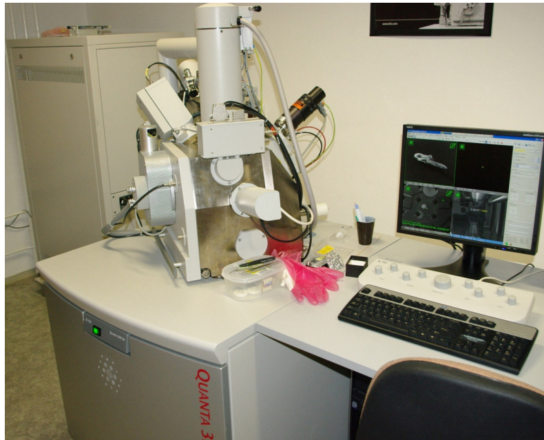
Obrázek 4.2. Skenovací elektronový mikroskop na ÚFKL, FEI Quanta 3D 200i, umožňuje práci v režimech SEM, ESEM, FIB a GIS.
