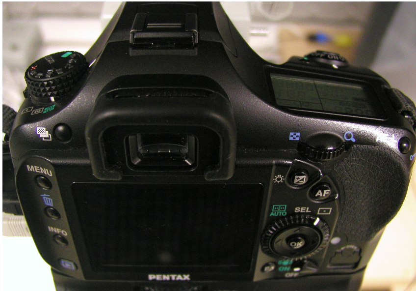
Obrázek 2.11. Přehled ovládacích prvků fotoaparátu Pentax K20.
