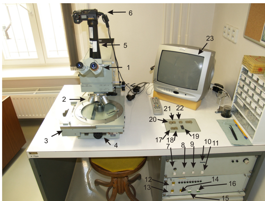
Obrázek 2.1. Základní přehled součástí mikroskopu a několika jeho ovládacích prvků: 1. binokulár, 2. sada objektivů, 3. posuvný stolek, 4. základna mikroskopu s osvětlením na průchod, 5. tubus s polní čočkou, 6. digitální fotoaparát, 7. hlavní síťový spínač, 8. rezervní spínač, 9. spínač xenonové výbojky, 10. počítadlo hodin provozu xenonové výbojky, 11. zapalovací tlačítko xenonové výbojky, 12. hlavní spínač základny mikroskopu, 13. spínač pohybu stínítka, 14. spínač svítidla na kloubovém rameni, 15. spínač svítidla pro osvětlení na průchod, 16. spínač ovládní posuvného stolku, 17. tlačítko pro jemné nastavení x-posuvu, 18. tlačítko pro jemné nastavení y-posuvu, 19. kolečko pro zaostření jemného převodu, 20. tlačítko pro aretaci x-posuvu, 21. tlačítko pro aretaci y-posuvu, 22. tlačítko pro rychlost fokuse.
