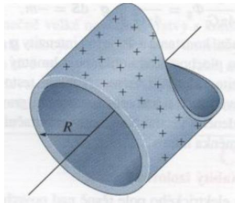
9. Velmi dlouhá vodivá válcová tyčinka délky  $L$  nesoucí náboj  $+Q$  se nachází uvnitř vodivé válkové trubky (rovněž délky  $L$ ), která má náboj  $-2Q$ , viz obrázek. Použitím Gaussova zákona najděte (a) elektrickou intenzitu pole v bodech vně vodivé trubky, (b) rozložení náboje na vodivé trubce, (c) elektrickou intenzitu pole mezi tyčinkou a trubkou. (HWR kap.24, př.27Ú)
