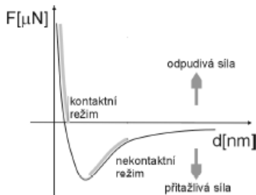
Obrázek 4.6: Působení sil u AFM
