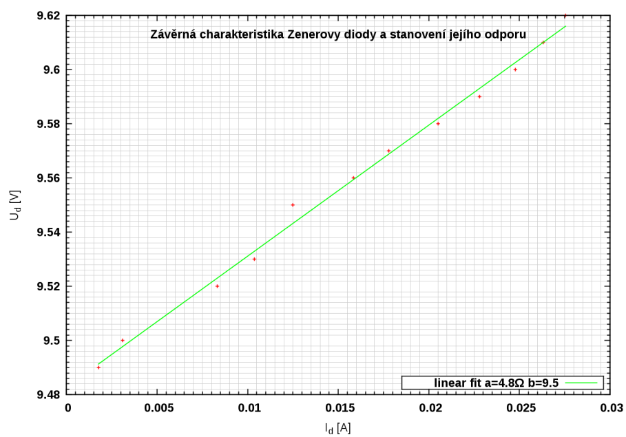
Obrázek 8: Závěrná charakteristika Zenerovej diódy od hodnoty Zenerovho napätia.
