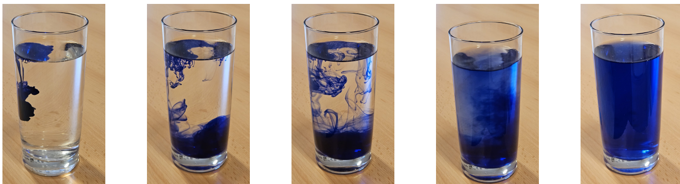
Obrázek 25: Různé fáze míchání inkoustu a vody. Ač se při tomto procesu nepředává teplo ani se nemění práce na teplo, entropie roste – na obrázcích postupně zleva doprava.
